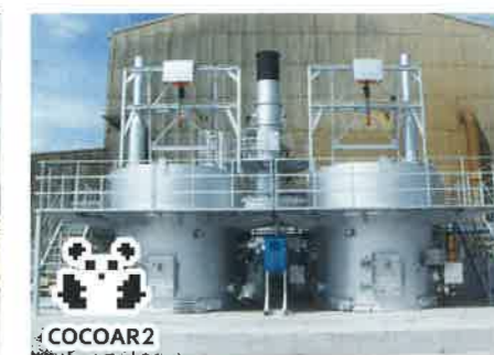
熱風供給装置用のサーマル熱源として、珪砂の乾燥に使用する、珪砂製造メーカーだからできるシステム。
